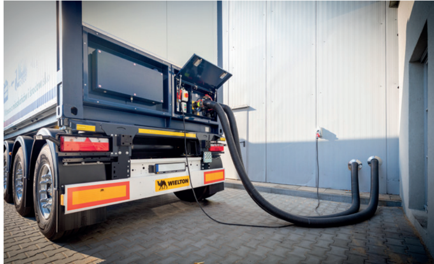
Bild 2. Der mobile Latentwärmespeicher mLWS050-00 58-1608 von PCM Energy wird mit zwei Schläuchen mit der Wärmequelle oder Wärmesenke verbunden
