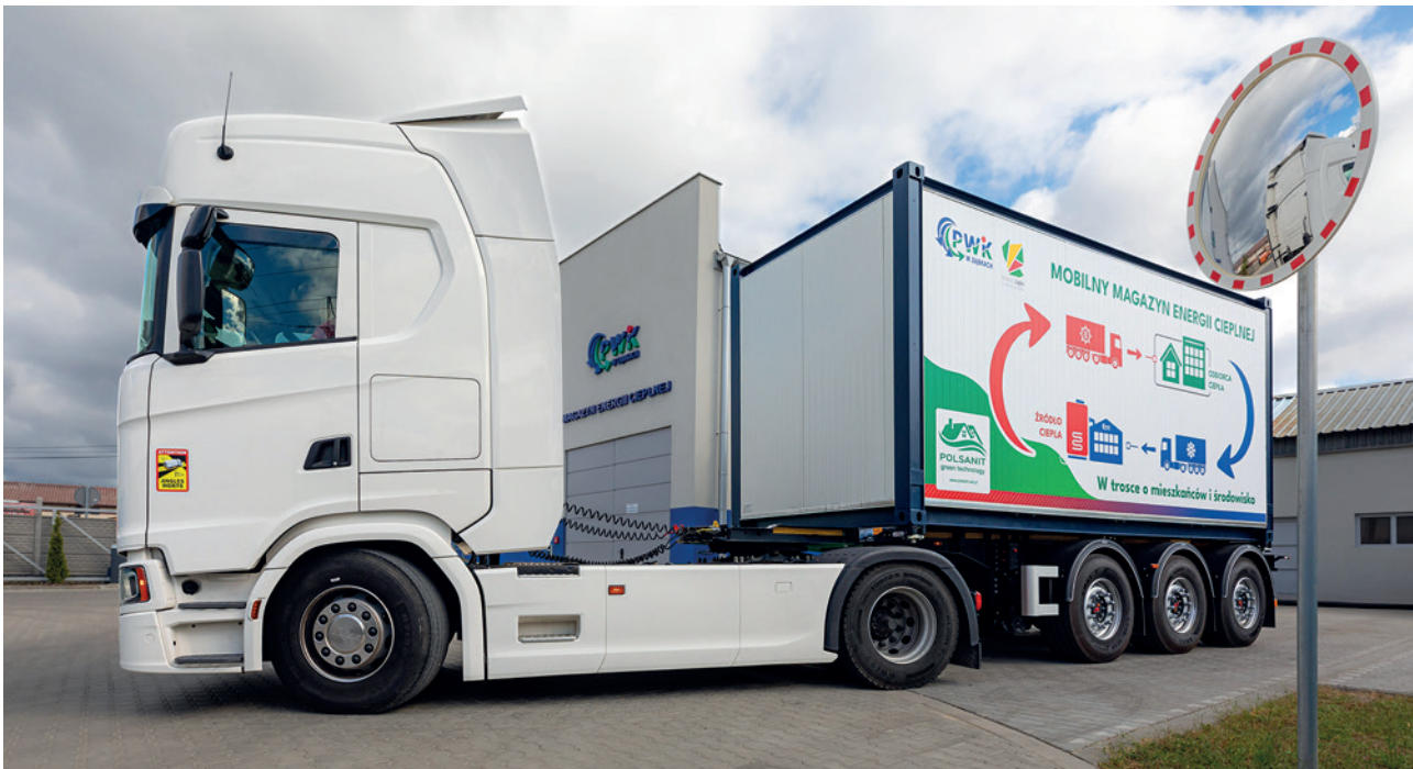
Mobiler Latentwärmespeicher im Einsatz bei PWiK w Ząbkach
